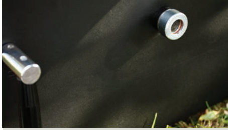
Alev izleme camı sayesinde gazifikasyon gözlemlenebilir
