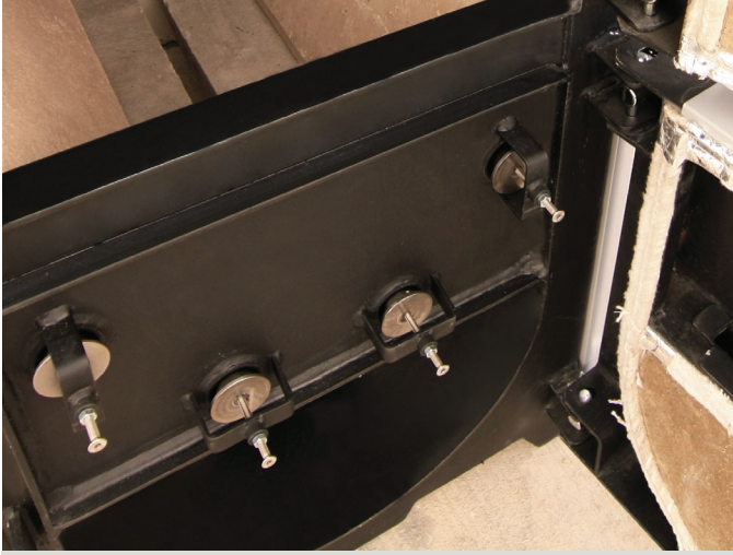
Birincil ve ikincil yanma havasının birbirinden bağımsız kontrolü sayesinde Avrupa Standartlarının ( EN 303-5 ) çok altında düşük emisyon değerleri
