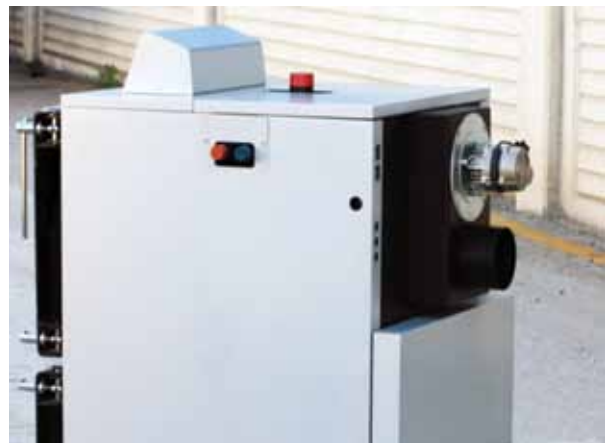
Вытяжной вентилятор поддерживает систему в состоянии постоянного вакуума, тем самым предотвращая возможную утечку дыма в окружающую среду.
