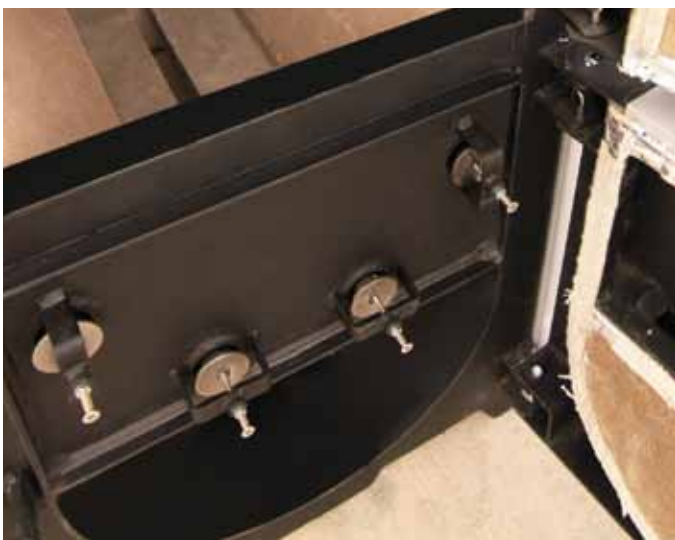
Независимые регулируемые первичный и вторичный воздухозаборники:
