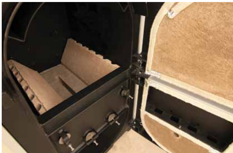
Внутренний вид каналов предварительного нагревания:
