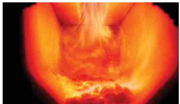
Обратное пламя в камере горения.
