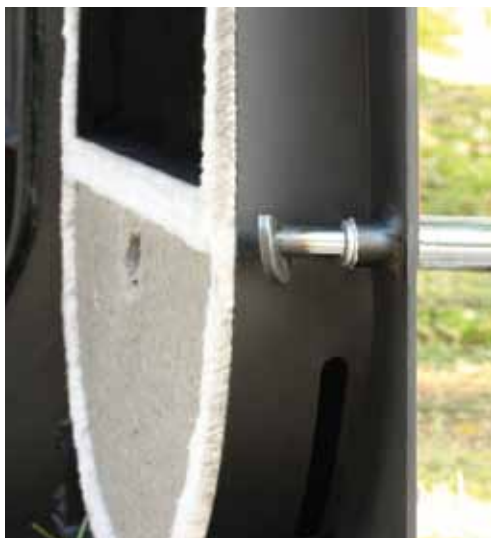
Специальные каналы внутри дверей обеспечивают предварительное нагревание за счет естественного воздушного потока:
