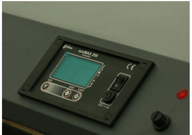
Akıllı kumanda paneli baca gazı sıcaklığını algılayarak fanı otomatik olarak doğru kapasite için yönlendirir.
